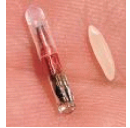
De RFID-chip, ernaast een rijstkorrel
